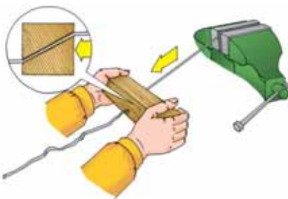
Мал. 120. Правлення дроту протягуванням через отвір у дерев'яному бруску
