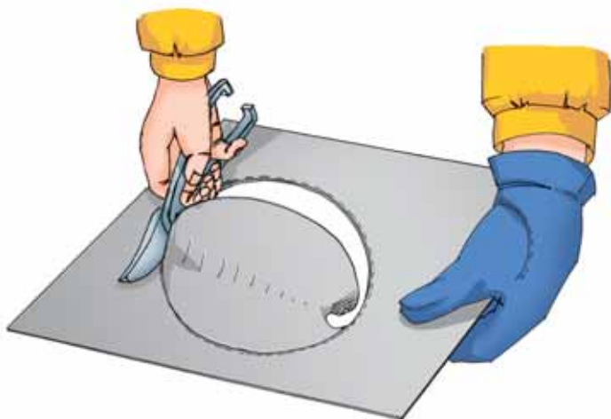
Мал. 77. Вирізання отворів у заготовках за допомогою ножиць із криволінійними лезами
