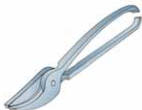
Мал. 79. Ножиці з криволінійними лезами для різання тонколистового металу
