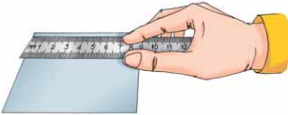
Мал. 63. Визначення розміру деталі за допомогою масштабної лінійки
