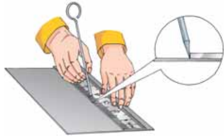
Мал. 69. Рисувалку нахиляють у бік від лінійки на кут, що відповідає куту загострення робочої частини інструмента
