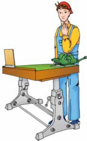
Мал. 9. Перевірка правильності регулювання висоти робочого місця під час виконання слюсарних робіт
