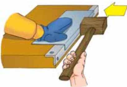
Мал. 108. Згинання країв заготовки для фальцювання
