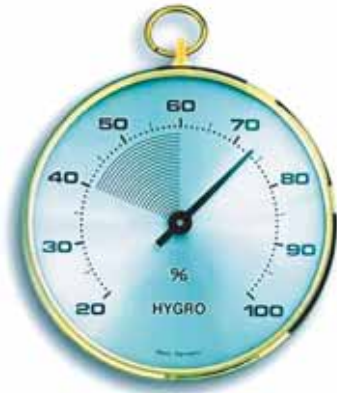
Мал. 217. Гігрометр дозволяє визначити рівень вологості повітря
