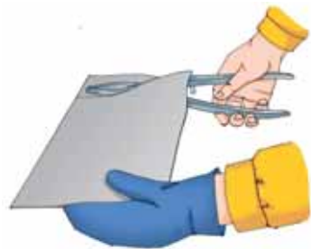
Мал. 74. Хватка ножиць при різанні тонколистового металу
