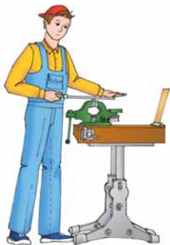
Мал. 83. Положення корпусу під час обпилювання деталі
