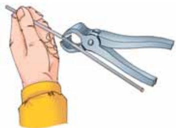
Мал. 130. Прийом різання дроту монтажними кусачками
