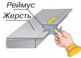
Мал. 118. Розмічання відгінів фальцювання рейсмусом
