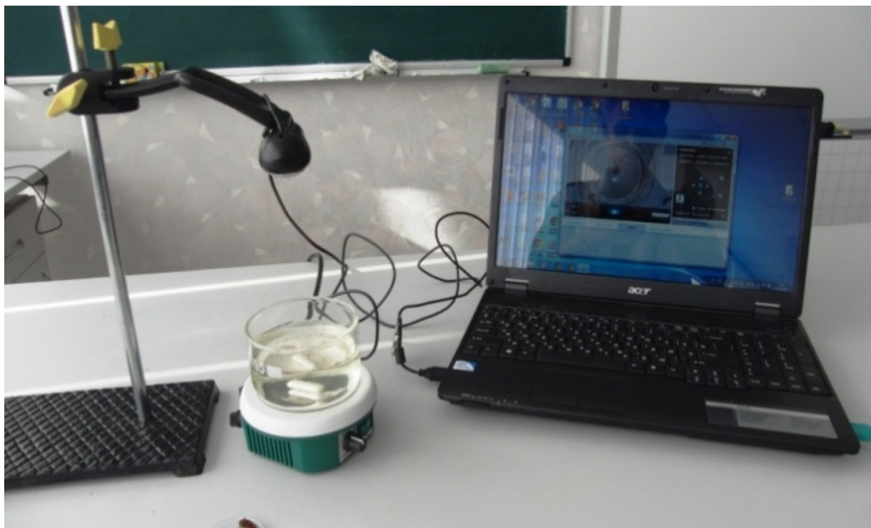
Рис. 4.15. Дослідження особливостей руху рідин у водяному вирі: лабораторна установка
