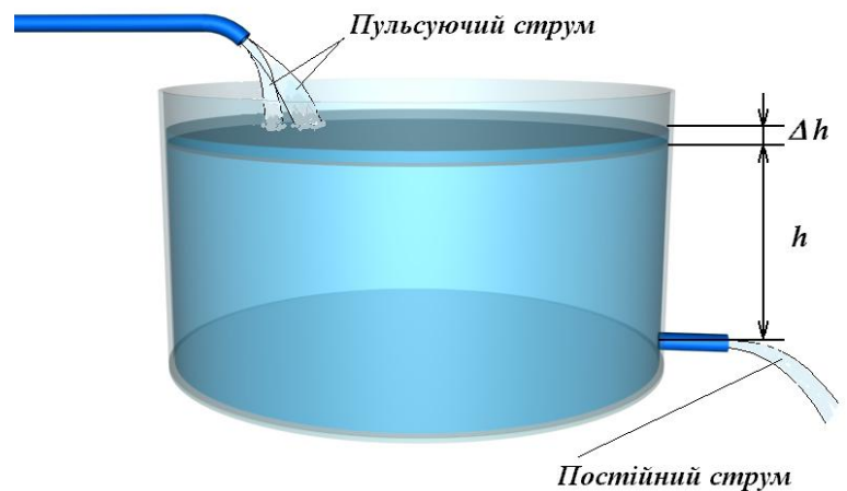
Рис. 2. 29. Модель-аналогія фільтра для згладжування пульсацій електричного струму – ємність для води великого об'єму.
