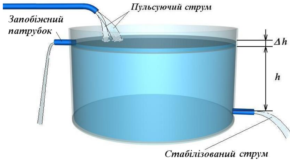
Рис. 2. 31. Модель-аналогія стабілізатора напруги – модель запобіжного патрубка водяного насоса.
