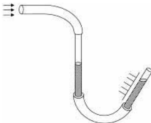
Рис. 2.10. Схема удосконаленого рідинного анемометра
