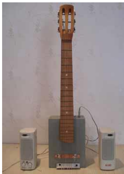
Рис. 3.6. Діюча модель електрогітари з оптичним звукознімачем (патент України № 23109U)
