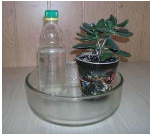
Рис. 2.18. Пристрій для автоматичного поливу кімнатних рослин (діюча модель)
