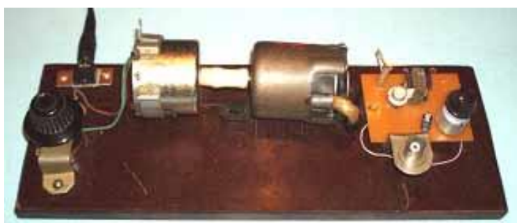
Рис. 2.6. Діюча модель механізму регулювання частоти обертання вітрогенератора (патент України №16959 U)
