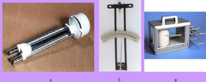
Рис. 3.5 Прилади для вимірювання відносної вологості повітря
