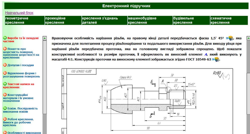
Рис. 4.9. Електронний підручник ЕНМК «Графіка», що містить детальний аналіз робочого кресленника ніпеля
