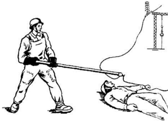
Рис. 3.2. Звільнення потерпілого від дії струму в електроустановках напругою понад 1000 В ізольованою штангою
