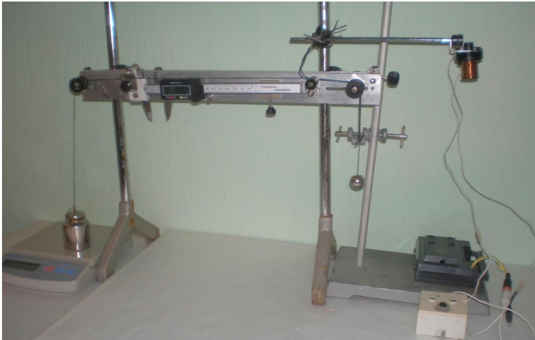
Рис. Д.3. Експериментальна установка з визначення добротності математичного маятника
