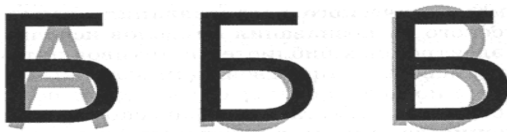
Рис. 2.56. Распознаваемый символ «Б» накладывается на векторные шаблоны символов (А, Б, В и т. д.)
