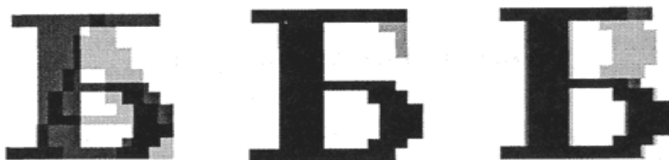
Рис. 2.55. Распознаваемый символ «Б» накладывается на растровые шаблоны символов (А, Б, В и т. д.)
