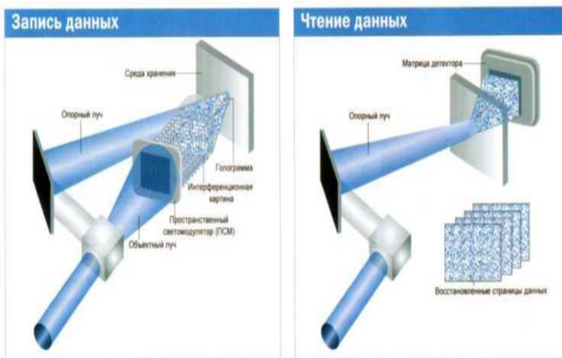
Рис. 3.7. Методы записи и чтения данных с голограммы
