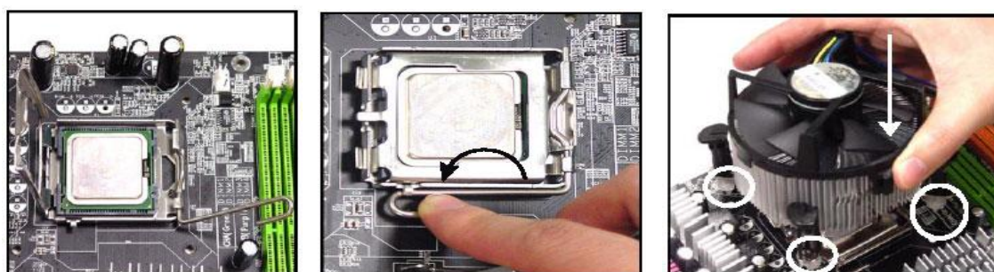
Рис.2.4. Робота з радіатором по отворах материнської плати
