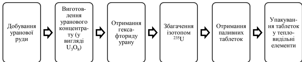
Рис. 4.8. Виробничий процес перетворення урану в ядерне паливо
