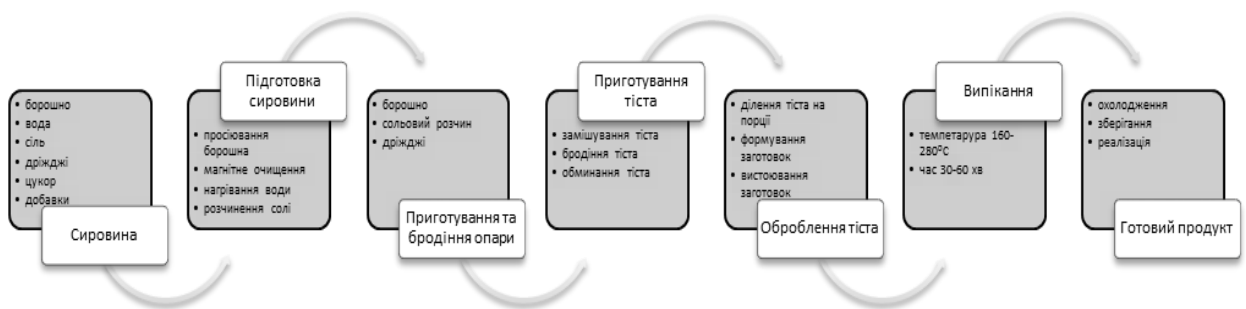
Рис. 4.18. Узагальнена модель виробництва хліба опарним способом
