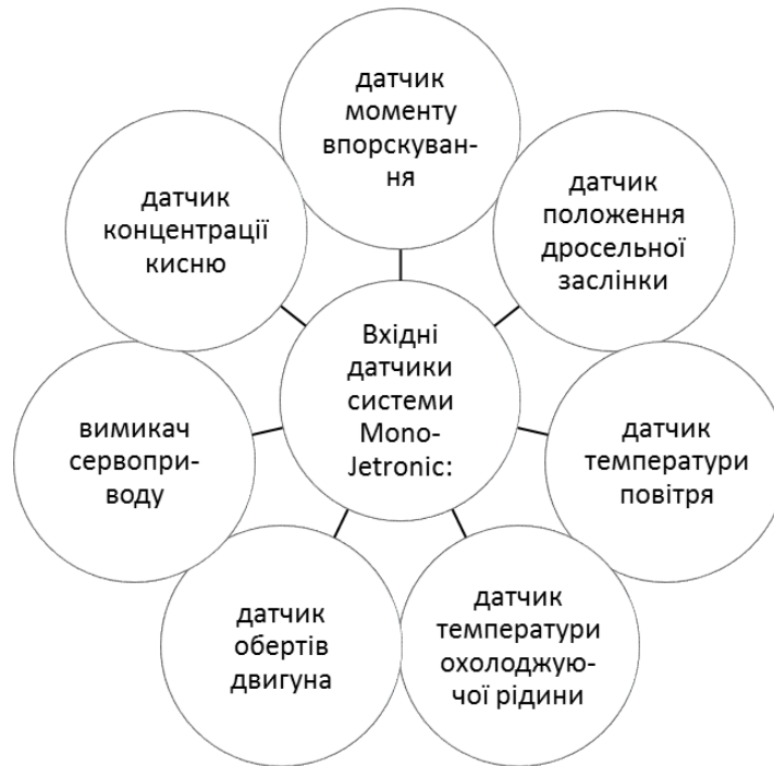
Рис. 2.5. Вхідні датчики системи Mono-Jetronic
