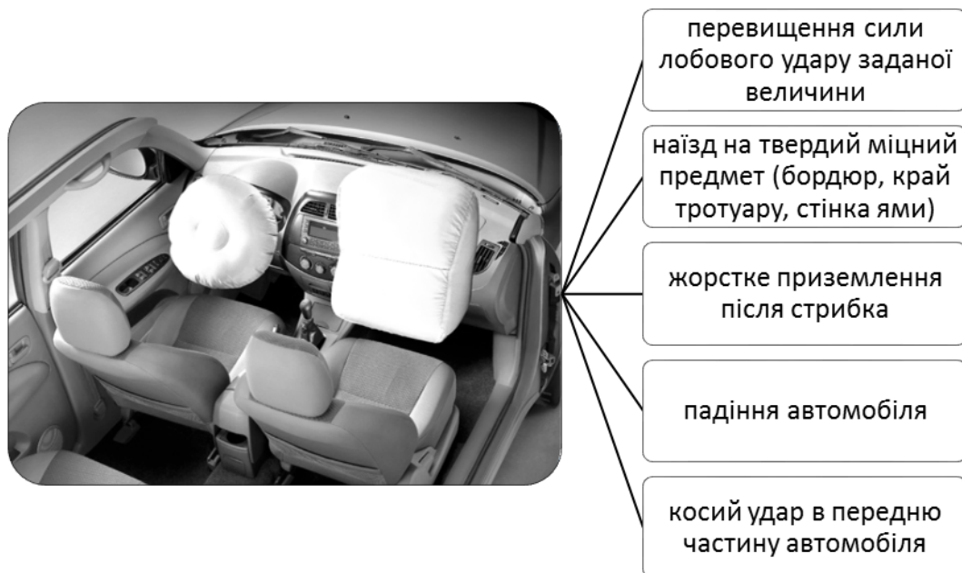
Рис. 2.30. Умови спрацювання фронтальних подушок безпеки
