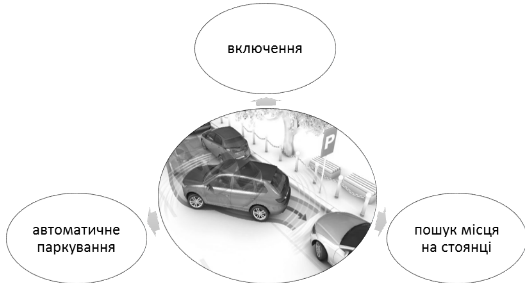
Рис. 2.23. Режими роботи паркувального пілота
