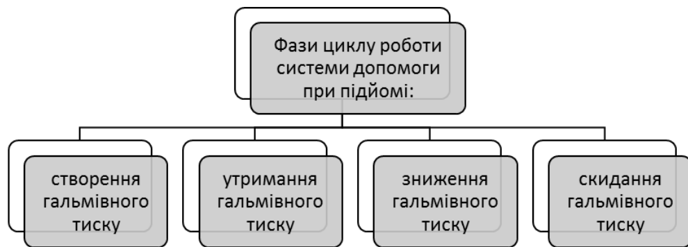
Рис. 2.20. Фази циклу роботи системи допомоги при підйомі
