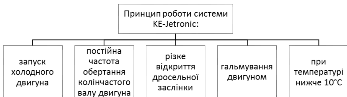
Рис. 2.9. Принцип роботи системи KE-Jetronic
