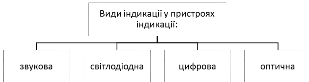
Рис. 2.22. Види індикації у пристроях індикації
