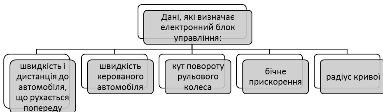
Рис. 2.25. Дані, які визначає електронний блок управління адаптивного круїз-контролю
