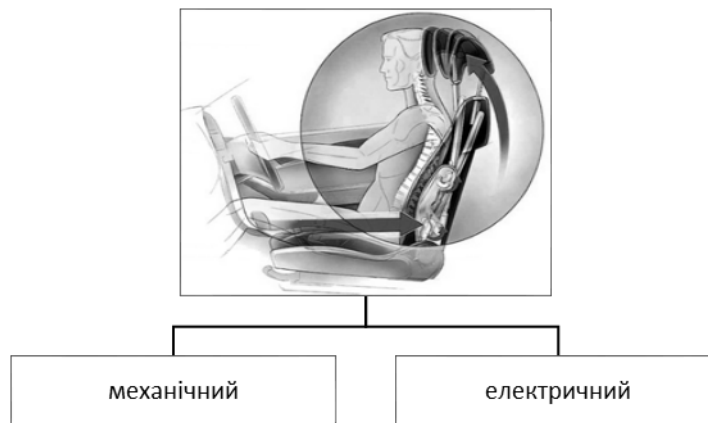
Рис. 2.31. Види приводу активного підголівника
