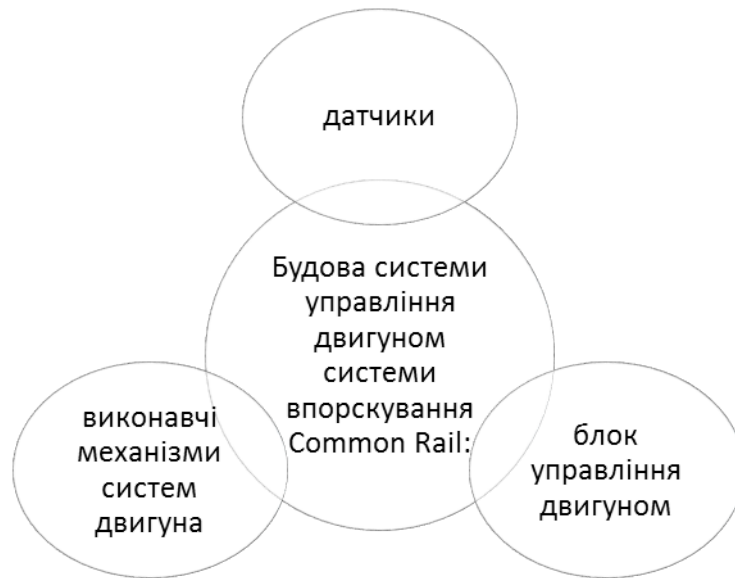
Рис 2.13. Будова системи управління двигуном системи впорскування Common Rail
