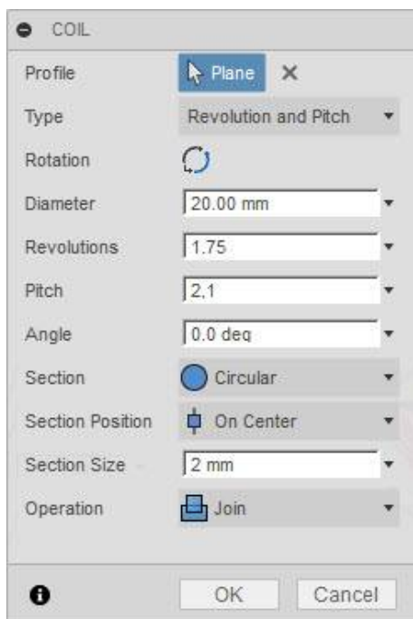
Рис. Д.5. Параметри опорних витків у діалоговому вікні інструмента Coil .
