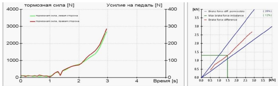
Рис. 2. Результати вимірювань ефективності гальмування передньої осі автомобіля при рекомендованому тиску повітря у шинах
