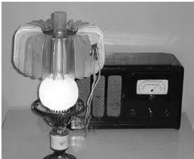
Термоелектричний генератор типу «Ромашка»
