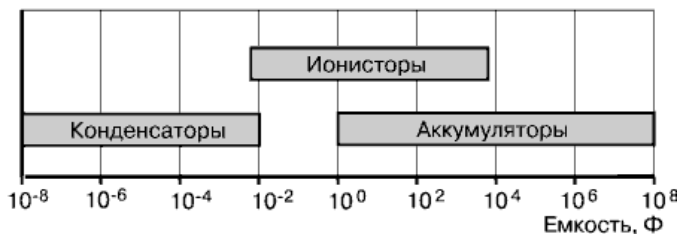
Рис. 2. Сравнительная характеристика емкости конденсаторов, ионисторов и аккумуляторов
