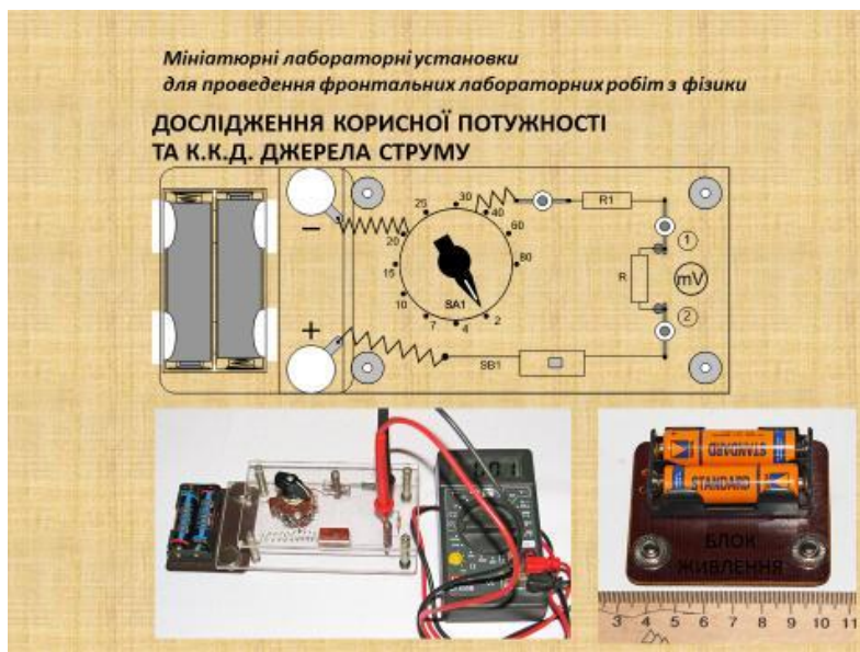
Рис. 1. Принципова схема та зовнішній вигляд мініатюрної лабораторної установки для лабораторної роботи “Дослідження корисної потужності та к.к.д. джерела струму”
