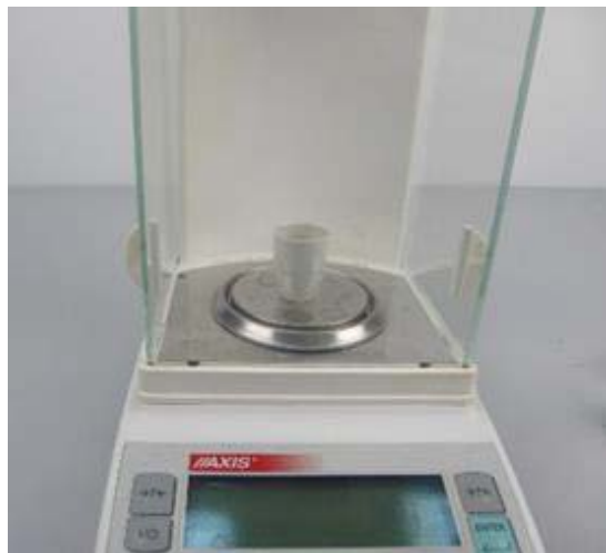
Рис. 2. Електронні терези з бюксом, що містить висічку
