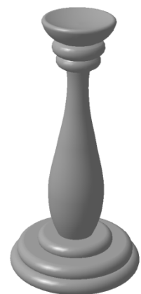
Рис. 8. Твердотільна модель свічника, виконана за ескізом шляхом обертання
