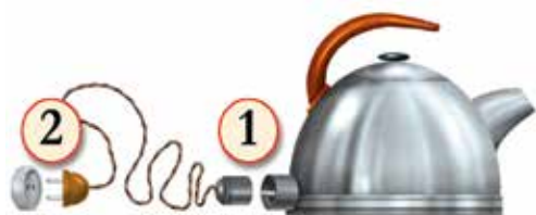
Мал. 51. Порядок вмикання електроприладу
