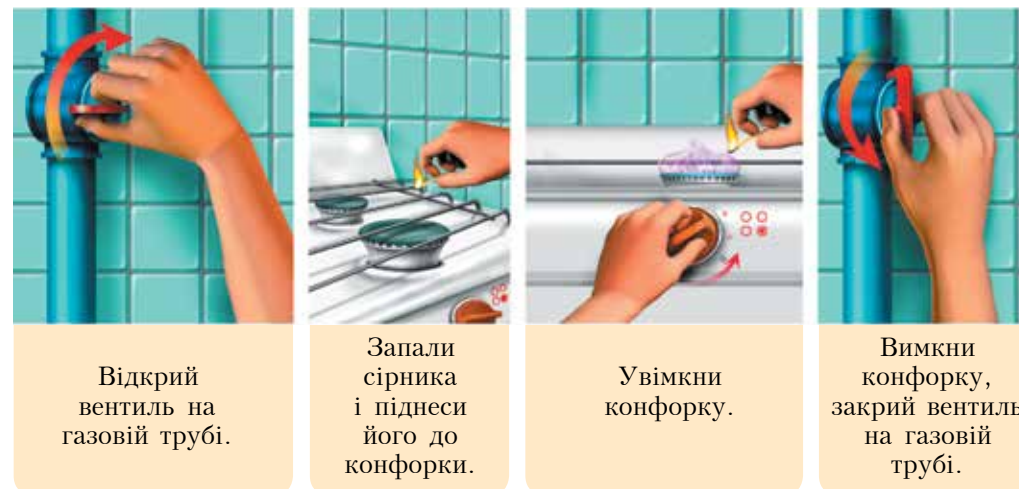
Мал. 52. Порядок вмикання і вимикання газової конфорки
