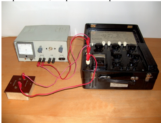
Рис. 5.8. Загальний вигляд лабораторної установки «Дослідження залежності напруги на клеммах джерела струму від сили струму в колі при постійній ЕРС»
