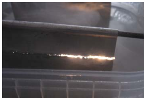
Рис. 5. Виникнення дугових розрядів під час тунельного оксидування
