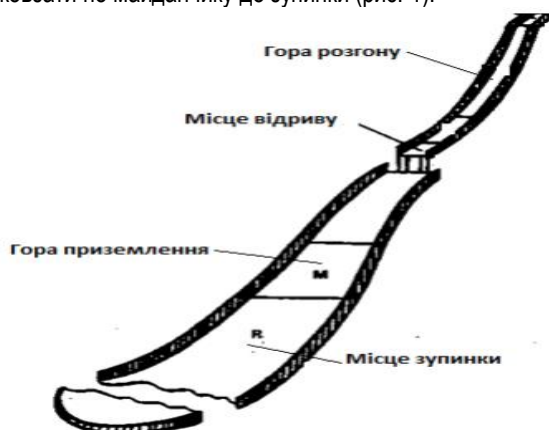
Рис. 2 - Стрибки на лижах з трампліну Усі трампліни відрізняються за потужністю (довжина зони розгону) від 30 до 120 метрів: дитячі трампліни – 30-40 м; юнацькі – 40-60 м; юніорські – 70-90 м; чоловічі – 90-120 м.
