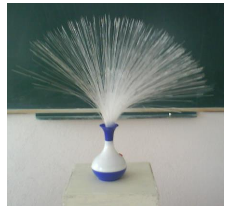
Рис. 2.103. Світловолокно – основна складова світильника.
