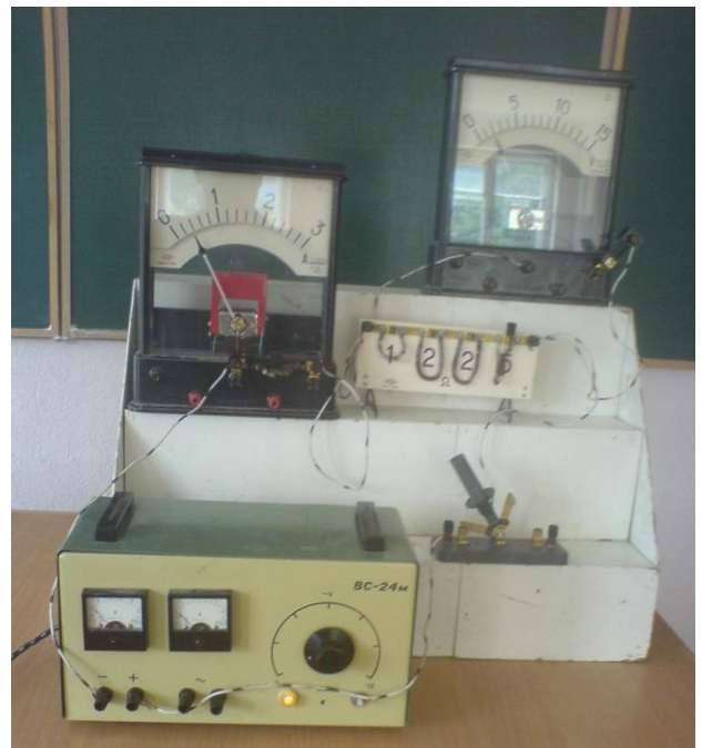
Рис. 2.87. До перевірки закону Ома для ділянки кола.
