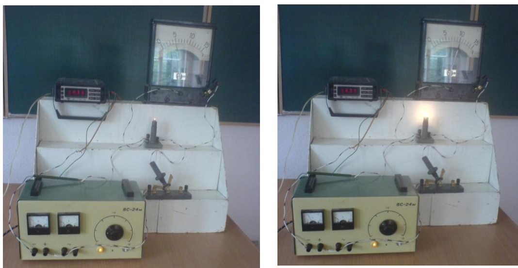
Рис. 2.5. Демонстрація проблемного досліду “Залежність опору металевих провідників від температури”.
