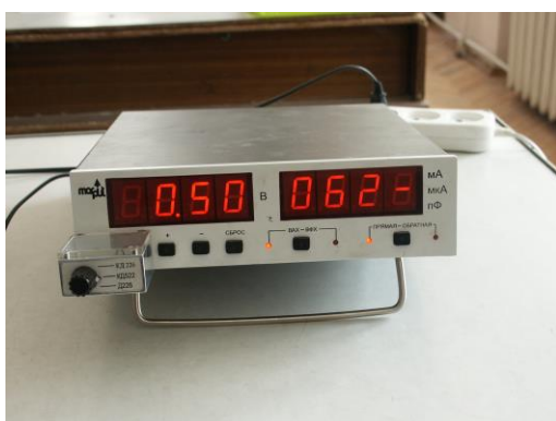
Рис. 2.10. Цифрова лабораторна установка “Зняття вольт-амперної характеристики напівпровідникового діода”.
