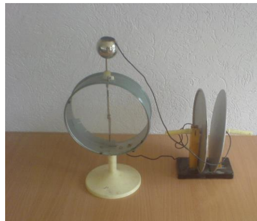
Рис. 2.80. Демонстрація поляризації діелектриків.
