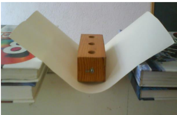
Рис. 2.68. Демонстрація залежності міцності зразка від його форми.
