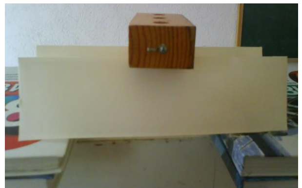
Рис. 2.68. Демонстрація залежності міцності зразка від його форми.
