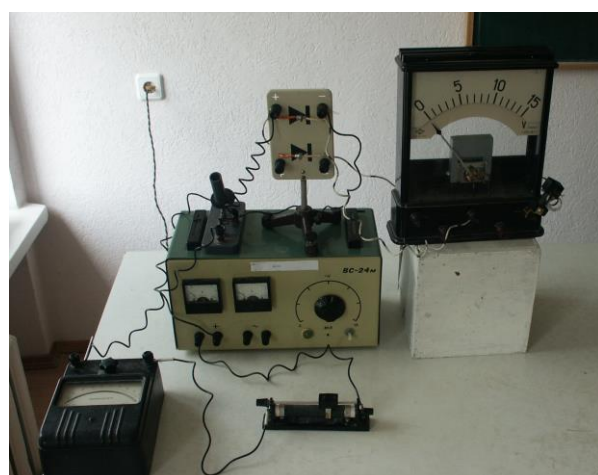
Рис. 2.11. Лабораторна установка “Зняття вольт-амперної характеристики напівпровідникового діода”, складена учнями.
