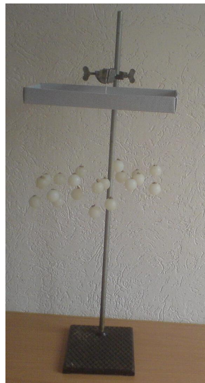
Рис. 2.20. Модель для демонстрації руху частинок в аморфному тілі.
