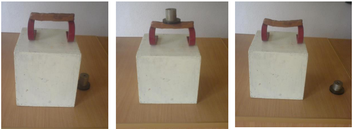
Рис. 2.53. Демонстрація “Пластичні властивості твердих тіл”:
