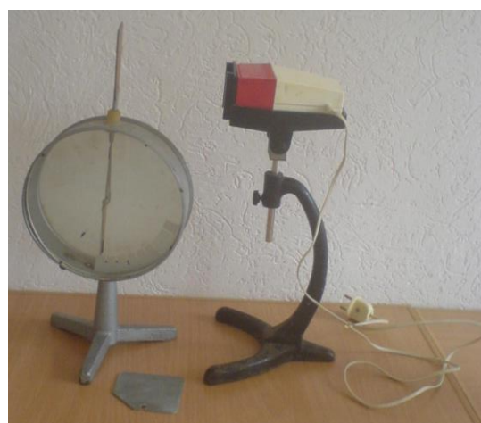
Рис. 2.89. Демонстрування явища зовнішнього фотоелектричного ефекту.
