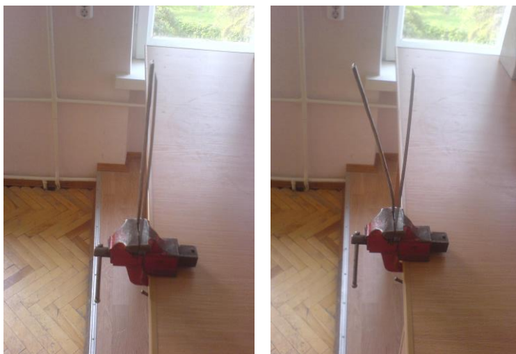
Рис. 2.52. Демонстрація “Пружна і залишкова деформації”: стальна пластина випрямилася після припинення дії зовнішньої сили, а свинцева – залишилася зігнутою.
