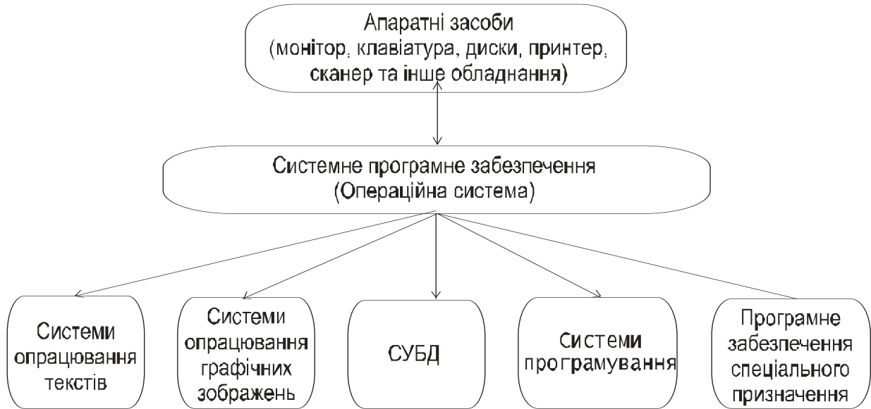
Рис. 2.1. Взаємозв'язки апаратних засобів, системного та прикладного програмного забезпечення
