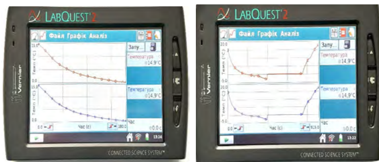
Рис. 10. Суміщення кривих замерзання води і розморожування льоду
