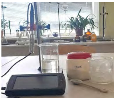
Рис. 1. Загальний вигляд установки дослідження процесів заморожування та розморожування води в лабораторії Vernier LabQuest
