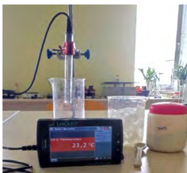
Рис. 8. Температура розморожування води наприкінці експерименту
