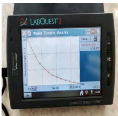
Рис. 5. Графічна візуалізація процесу заморожування води
