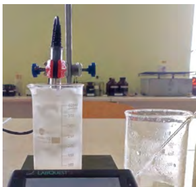
Рис. 3. Фіксація початку замерзання води в пробірці
