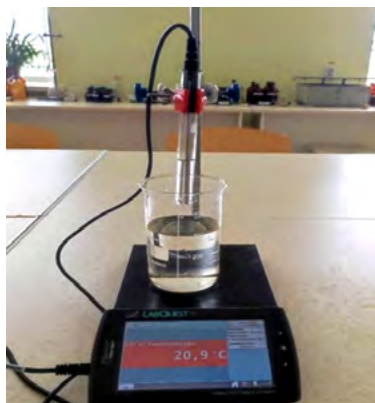
Рис. 7. Фіксація температури води напочатку експерименту
