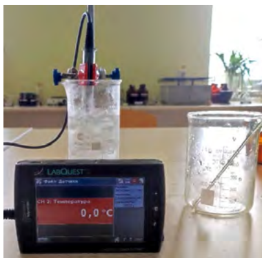
Рис. 6. Фіксація температури замерзання води Vernier LabQuest
