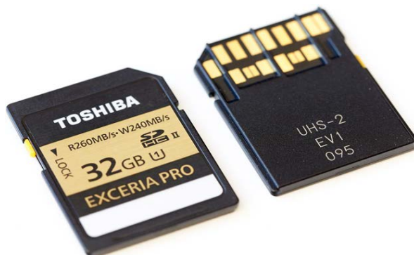
Рис. 5.43. SDHC UHS-II з двома рядами контактів
