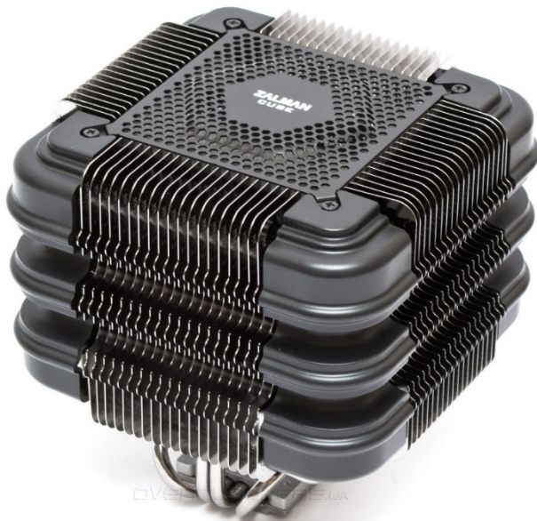
Рис. 3.7. Пасивна система повітряного охолодження процесора
