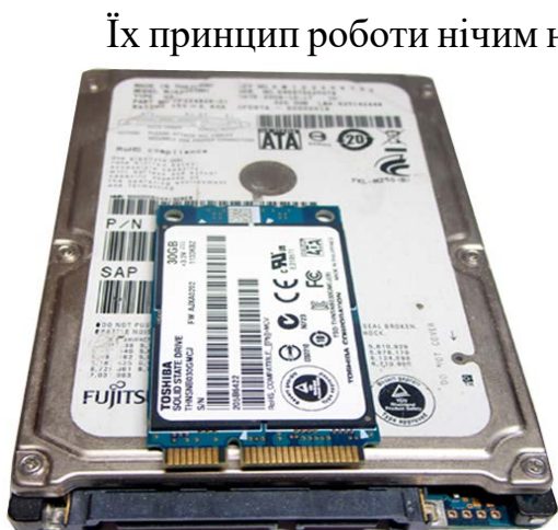
Рис. 5.16. mSATA в порівнянні з 2.5"
