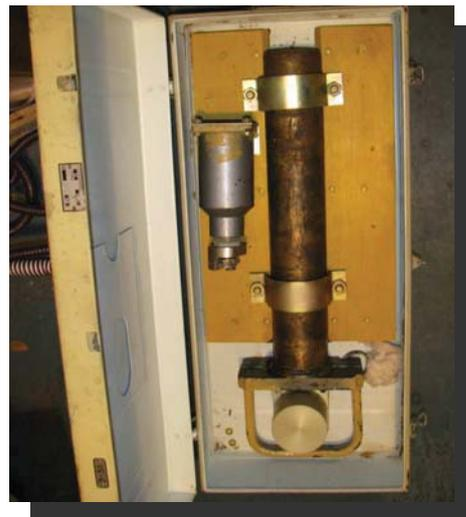
Рис. 3. Індукційний перетворювач швидкості
