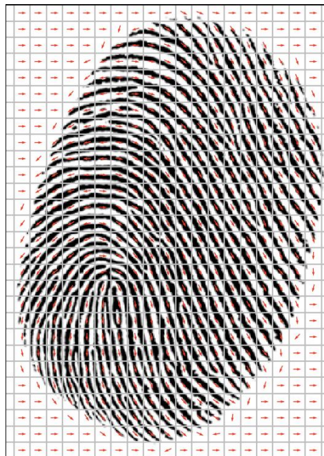
Рис. 3 – ориентации папиллярных линий, вычисленные с использованием оператора Собеля, наложенные на исходное изображение.
