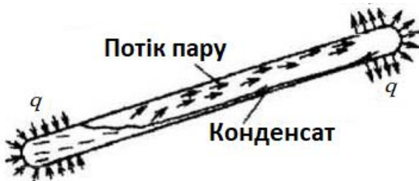
Рис. 5.19. Схема роботи теплової труби
