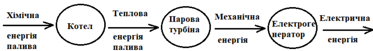
Рис. 7.7. Схема послідовного перетворення енергії в ТЕС
