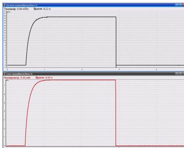
Рис. 6. Зміна струму у котушці індуктивності (нижній графік) та індукції магнітного поля (верхній графік) від часу.
