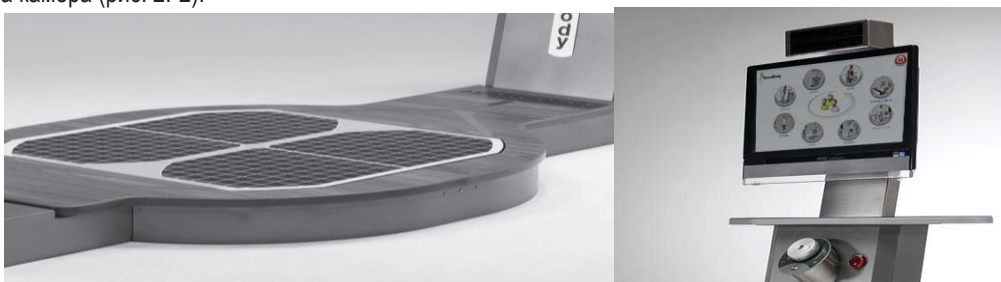
1. 2. Рис. 2. Сенсорна платформа та інтегрована 3D-камера.
