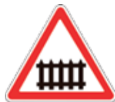
Залізничний переїзд зі шлагбаумом
