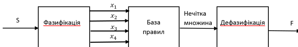
Рис. 1. Модель формування лінгвістичної оцінки рівня знань, де S – сума балів, яку отримав студент, x_1 - x_4 – рівні оцінки.
