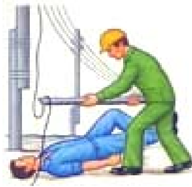
Рис. 6.20. Звільнення потерпілого від дії електричного струму відкиданням проводу сухою палицею
