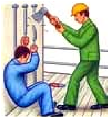
Рис. 6.21. Звільнення потерпілого від дії електричного струму перерубуванням проводів сокирою
