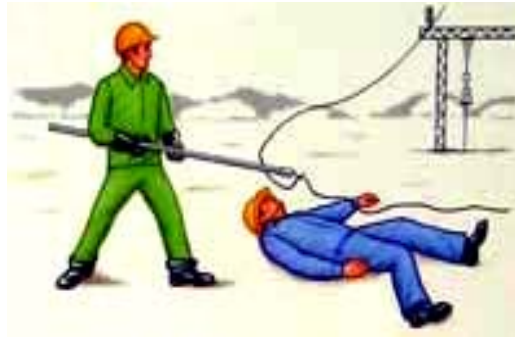
Рис. 6.23. Звільнення потерпілого від дії електричного струму напругою вище 1000 В
