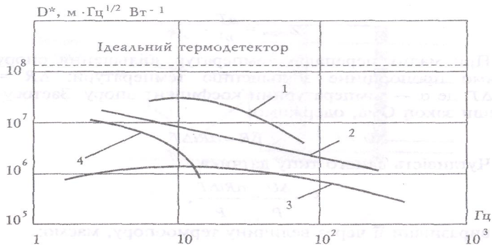
Рис. 2.8. Виявна здатність приймачів інфрачервоного випромінювання 1 - клітинка Голя; 2 - піроелектричний; 3 - термістерний; 4 - термоелемент
