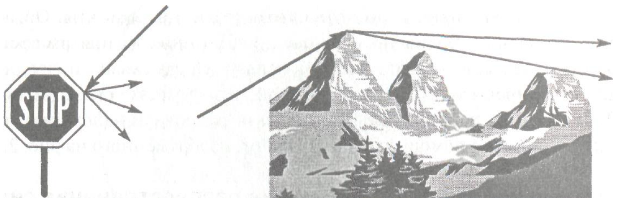
Рис. 3.15. Розсіювання і дифракція хвиль
