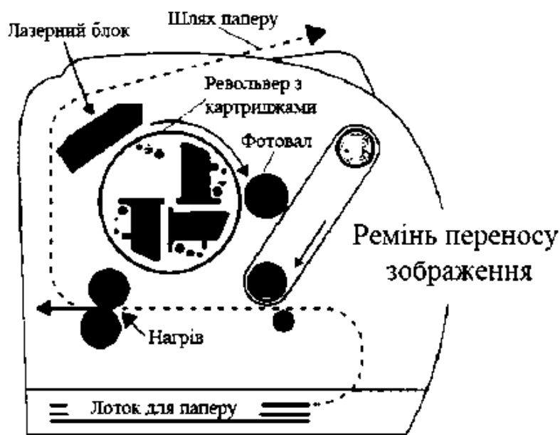
Рис. 6.33. Схема реалізації методу отримання 4-х послідовних зображень в лазерному принтері
