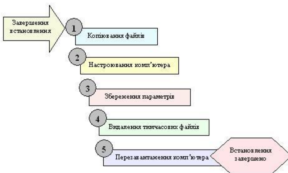
Рис. 1.5. Заключний етап встановлення
