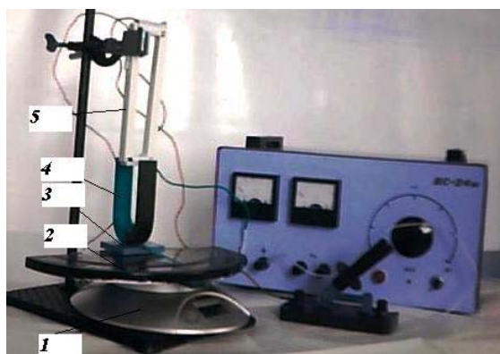
Рис. 2. Експериментальна установка для дослідження залежності сили Ампера від кута \alpha між вектором магнітної індукції та напрямком струму в провіднику
