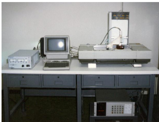
Рис. 1. Перший у світі 3D-принтер "SLA-1", 1984 рік
